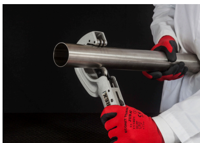
Fig. 52a - Cortar el tubo
