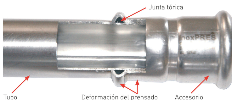
Fig. 9 – Unión prensada
