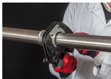
Fig. 52f - Montar el adaptador.
