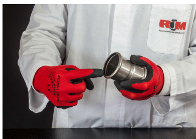
Fig. 52c - Comprobar la presencia de la junta tórica
